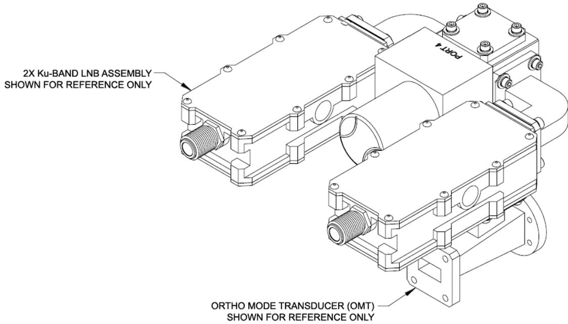
**Figure B-11. KT-0000191 LGaN Ku-Band Rx Switch Kit,
