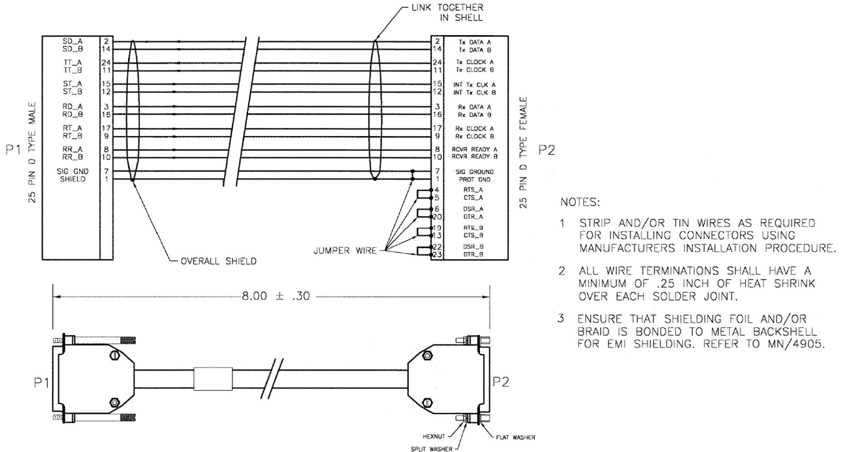
Figure A-3. EIA-530 DCE Conversion Cable (CAWR9718-1)
