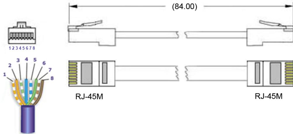
Figure A-6. Ethernet Data Cable (CEFD P/N PP/CAT5FF7FTGY)
