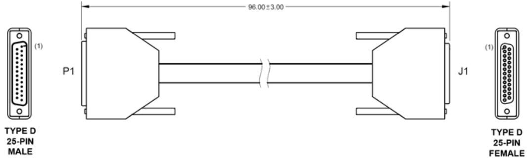
Figure A-2. CRS-500 CSU → DSU Control Cable (CEFD P/N CA-0000234)
