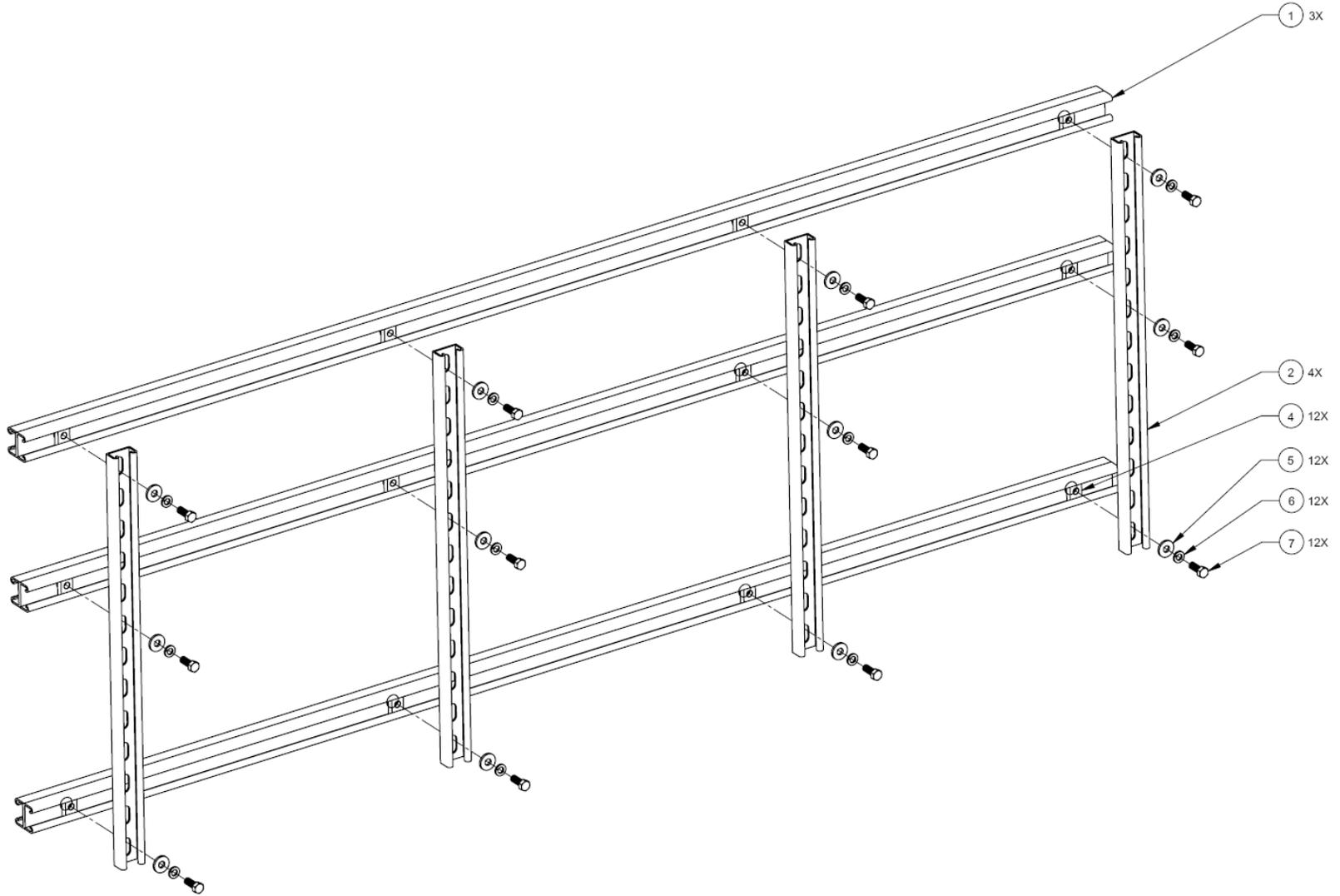
**Figure A-7. 1:2 Redundant HPOD Mounting Kit (KT-000017)**
