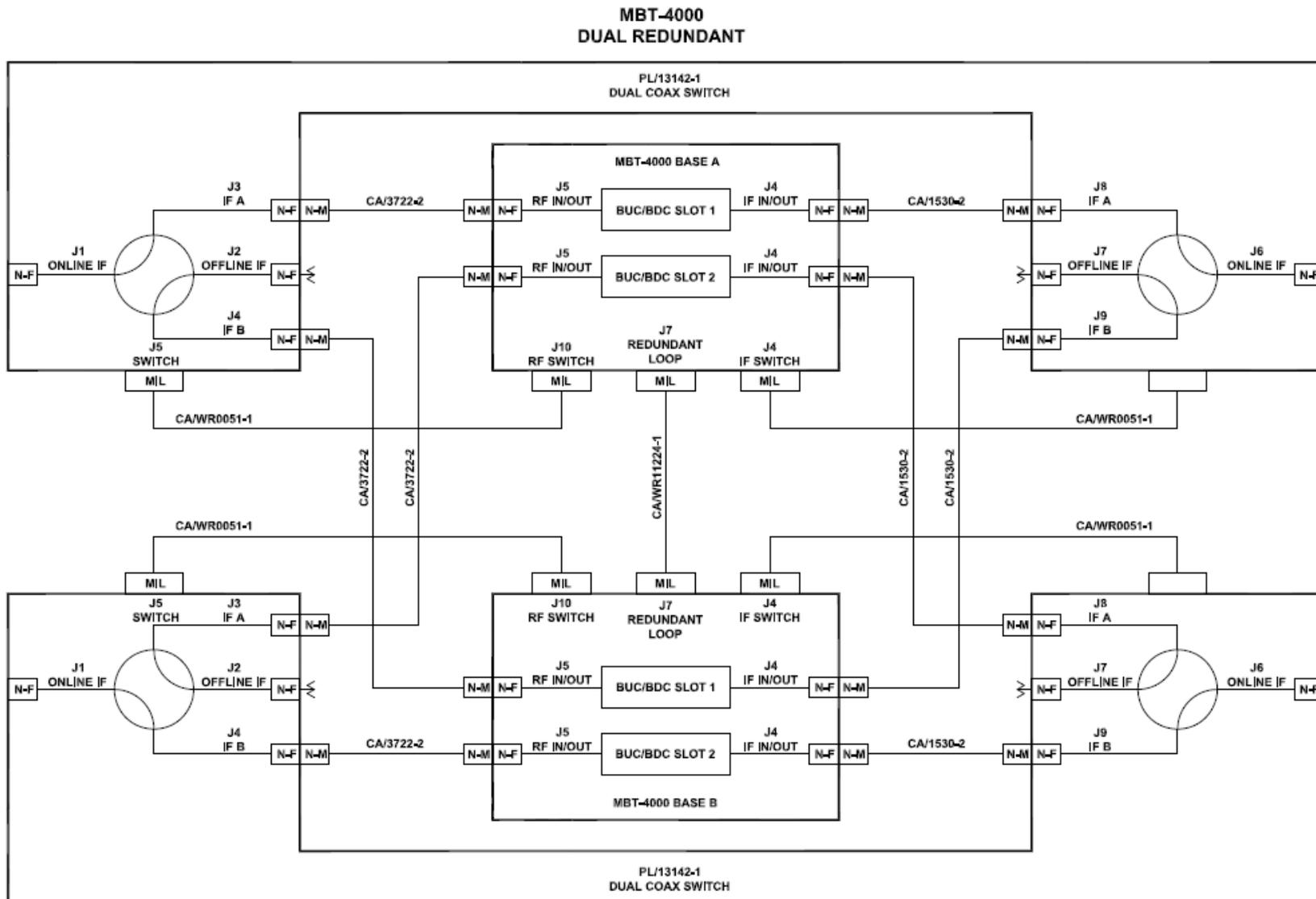
Figure C-3. Dual-Base Dual Redundant Operation
